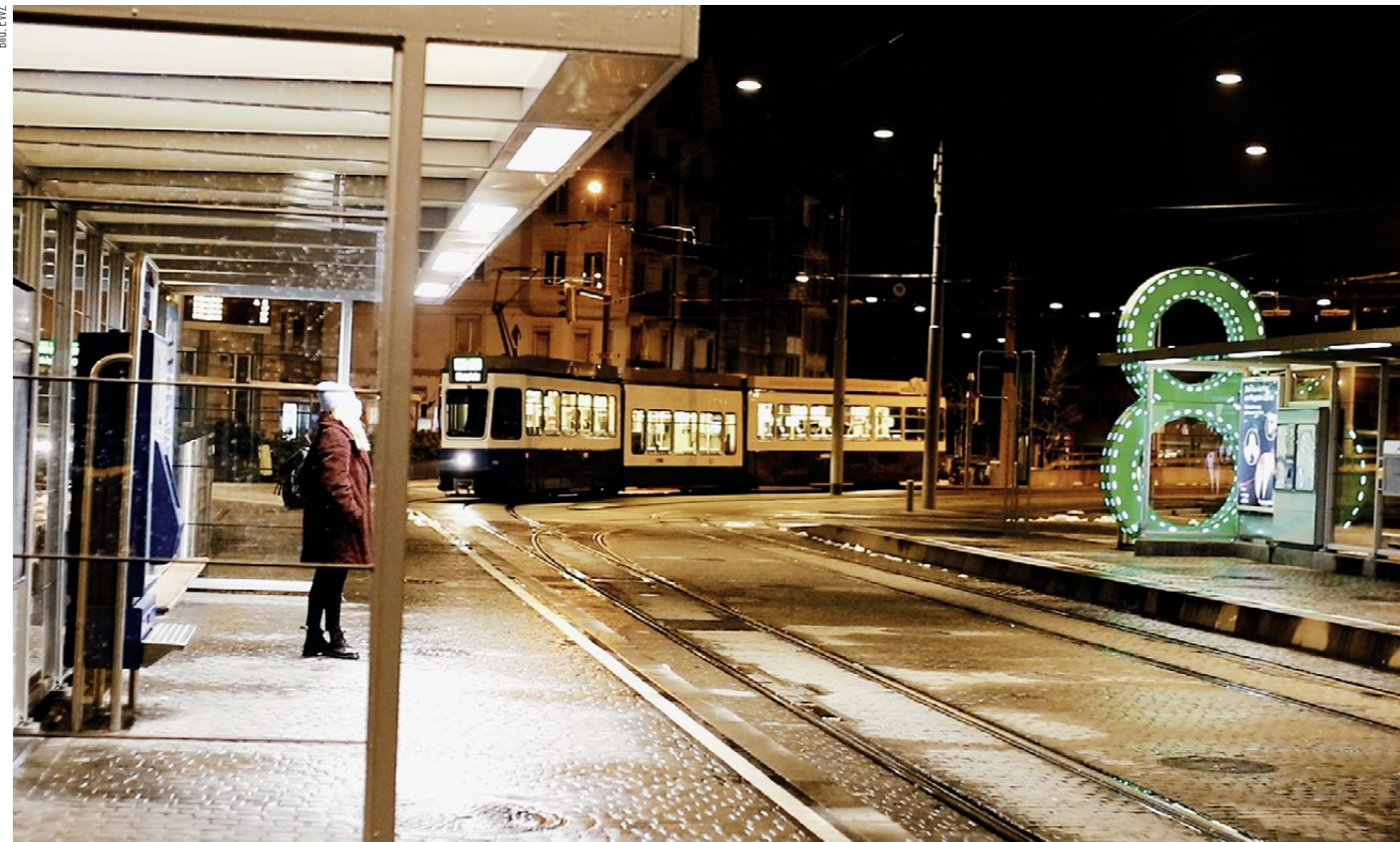
Die Haltestelle Hardplatz in Zürich wurde mit intelligenter Lichttechnik ausgestattet. Sobald sich ein Fahrgast dem Warteraum nähert, verstärkt sich die Beleuchtung. Die Verkehrsbetriebe Zürich wollen an allen Haltestellen die Leuchtstoffröhren durch bewegungsabhängige LED-Beleuchtung ersetzen.
